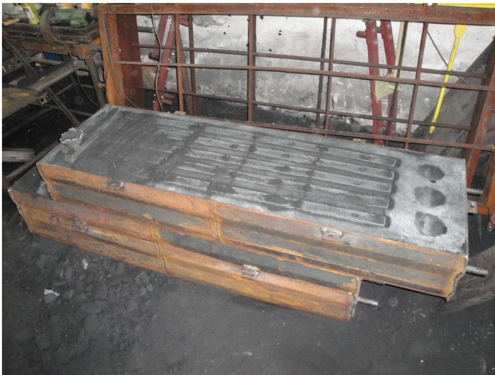
Rys. 5. Odlewy żeliwne ukazujące swobodny skurcz odlewniczy.
