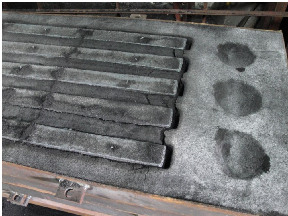
Rys. 6. Skurcz odlewniczy ukazany na odlewach żeliwnych belek podrusztowych.
