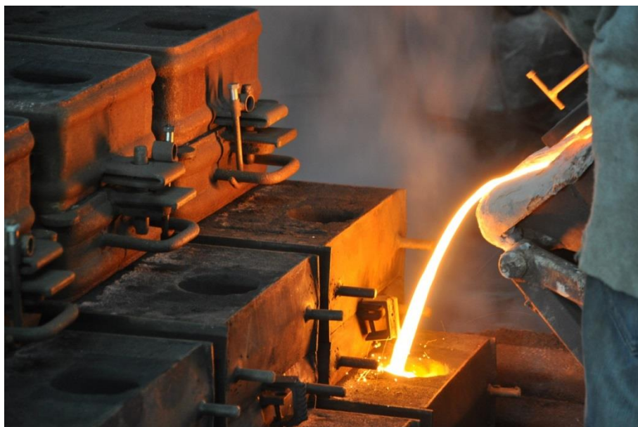
Rys. 1. Zalewanie ciekłym żelazem piaskowej formy odlewniczej.
